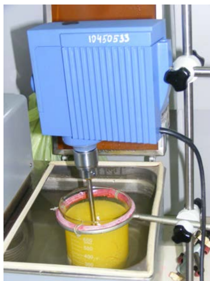
Рис. 2. Исследование объемного промывания биодизеля
