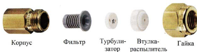
Рис. 6. Структура распылителя "Disc and Core"
