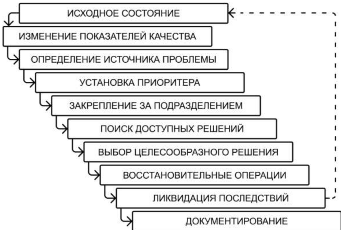
Рис. 1. Порядок операций при анализе и решению отказов оборудования
